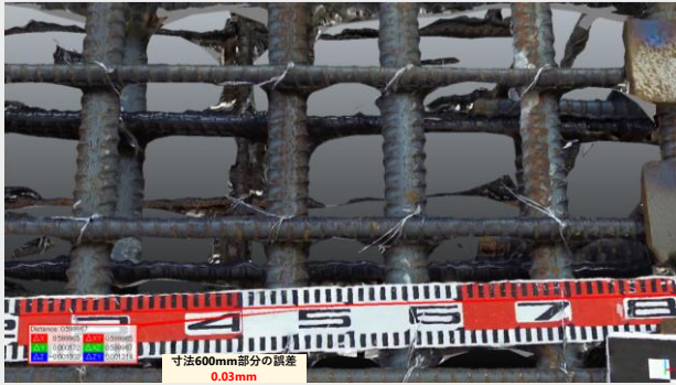
鉄筋の3D点群モデル
