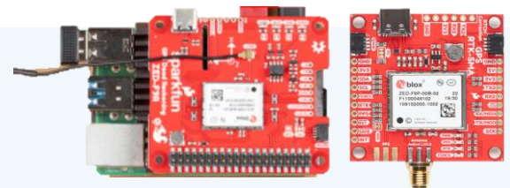
RTK-GNSSボードモジュール F9R (左) ; F9P (右)
